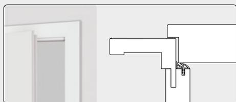
Bei der gefälzten Ausführung liegt das Türblatt auf der Bekleidung auf.
