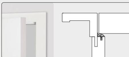
Bei der stumpfen Ausführung bildet das Türblatt eine bündige Ebene mit der Bekleidung.
